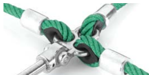
Grillete de 3 ojos de alta aleación incl. cross bolts M10 ideal para esquinas en redes hori- zontales para cuerda Hércules Ø 16 mm or Ø 18 mm para cadena No. 6 (incl. protección de de- dos) or. 8 o soporte adaptado de alta aleación
