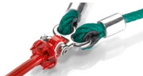
Grillete de dos ojos de alta aleación incl. cross- bolts M10 sin soporte, ideal para esquinas en redes horizontales para cuerda Hércules Ø 16 mm or Ø 18 mm, también disponible de 3 ojos
